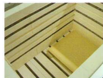
Cámara de cocción con 5 vías de calentamiento
