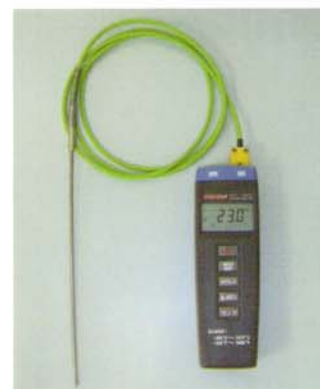
Termómetro para RAKU 100, de fácil funcionamiento, de fácil funcionamiento, sensor de temperatura NiCr-Ni, indicador de 20-1200 °C, posibilidad de conexión con un segundo sensor con cambio de la lectura.
