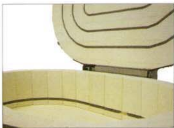
Interior del horno con calentamiento del anillo lateral inferior.
