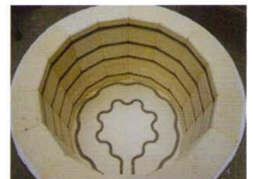
Calefacción de solera opcional para Top 140, Top 190 y Top 220
