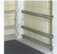
Libre radiación térmica a través de elementos calefactores en tubos de conducción cerámicos; posicionamiento óptimo para una muy buena distribución de la temperatura
