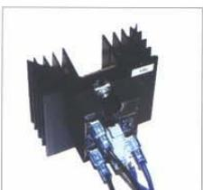
Relé semiconductor para regular el calor del horno. De funcionamiento silencioso y prácticamente inalterable, el relé semiconductor conmuta en ciclos cortos permitiendo un óptimo equilibrio en la curva de temperatura durante el proceso de cocción.
