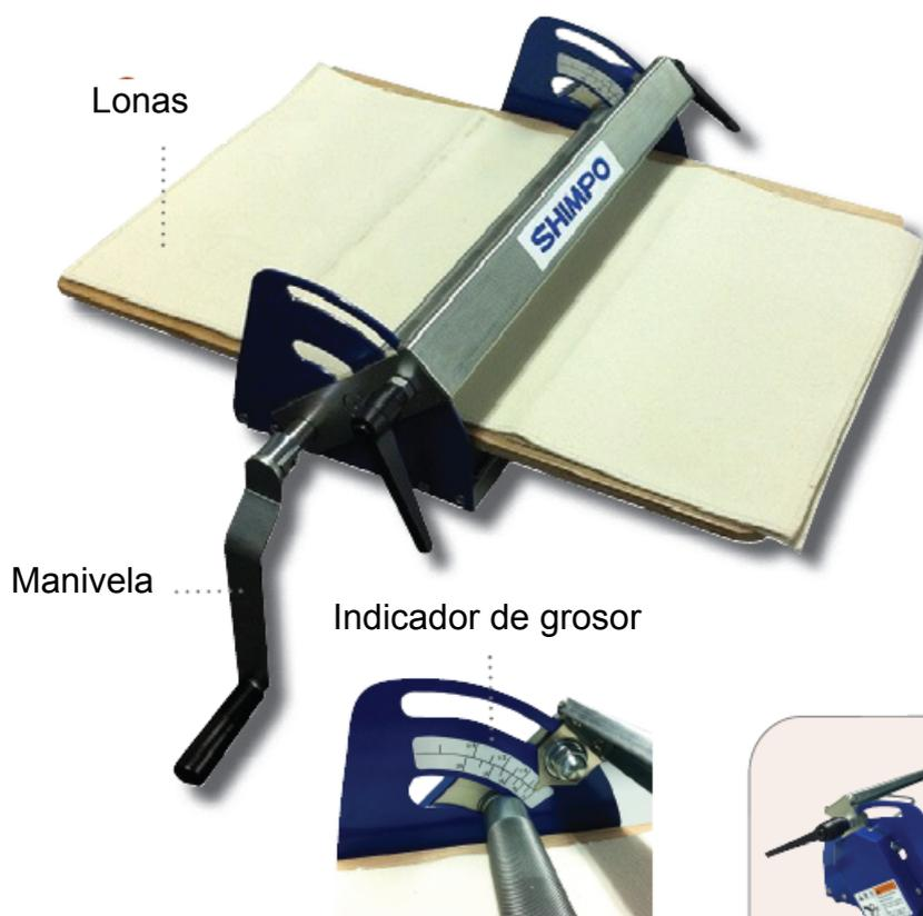
La nueva laminadora de sobremesa SHIMPO dispone de un sistema de doble rodillo con manivela e indicador de grosor provisto de un fino ajuste sincronizado que permite producir planchas de hasta 25 mm. Su ligereza (12,5 Kg) y su diseño compacto lo convierte en una máquina de fácil transporte y almacenaje. Sus dimensiones de plancha (400 x 600) la hacen ideal para todos los talleres y escuelas.
