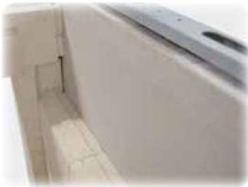
Estructura de aislamiento multicapa de ladrillos refractarios ligeros y un aislamiento posterior, que ahorra energía, adaptado a la temperatura máxima del horno.
