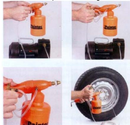
9. Cuando el bombeo se torne dificultoso (después de muchísimo uso), debe lubricar la sopapa (5) con vaselina. Para eso desenrosque la tapa (3) y extraiga la manija (2) de la cámara de aire (1).
