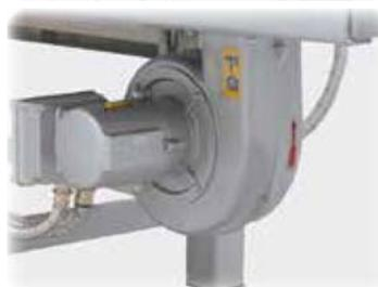
Ventiladores de refrigeración para acelerar el enfriamiento con la tapa cerrada
