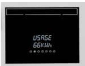
Visualización del consumo de corriente en kWh
