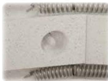
Termopar protegido integrado en el aislamiento
