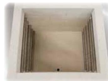
Los elementos calefactores en los tubos soporte aseguran una libre difusión del calor
