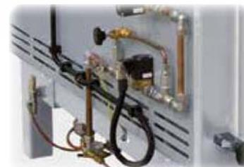
Tubería de gas y elemento térmico en el horno de cámara
