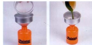
2. Llene el tanque hasta la mitad como máximo para dejar espacio para el aire y ajústelo firmemente a bomba (1-6)
