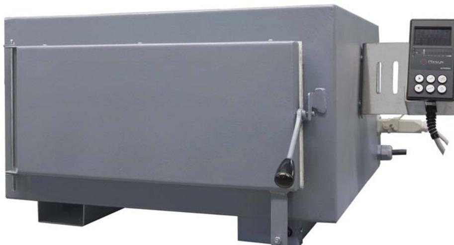
Su potencia es similar a cualquier placa eléctrica y se pueden conectar a la red doméstica sin ninguna instalación especial. Construidos para su utilización de forma continuada.
